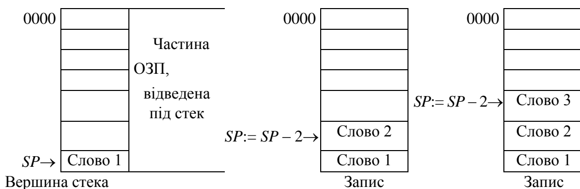
Рис. 5.36. Принцип роботи апаратно-програмного стека
