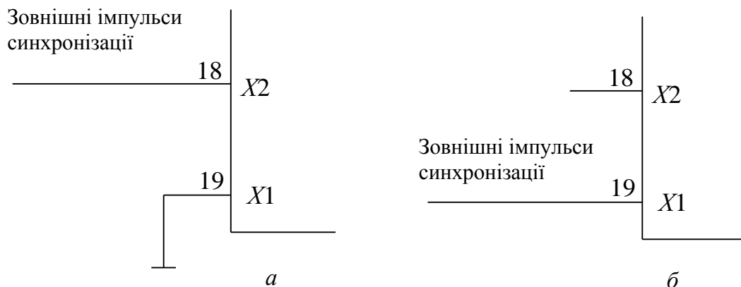
Рис. 7.9. Приєднання зовнішнього джерела тактових сигналів: a – для n -МДН; b – для КМДН
