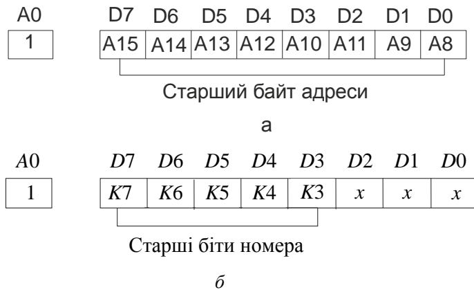
Рис. 6.66. Формати керувальних слів ініціалізації ICW2 : a – для системи з МП i8080 ; б – для систем з МП i8086
