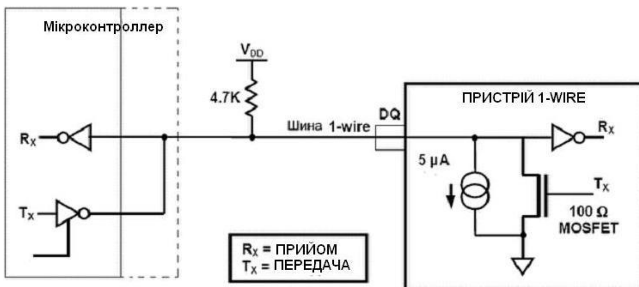
Рис. 1. 56. Схема обміну по 1-wire інтерфейсу
